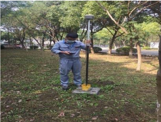
RTK 管口高程测量
